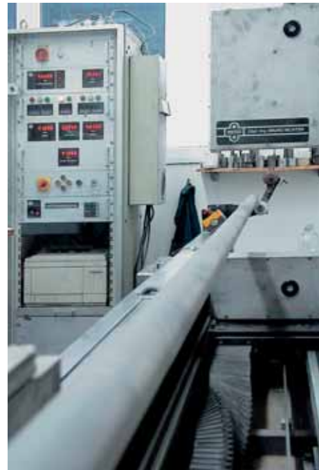
Laserprüfanlage für Rollen (Rundlauf/Durchbiegung)
