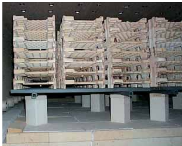
Balken aus Silit® SK und AnnaSicon® RT für die Dachziegelherstellung
