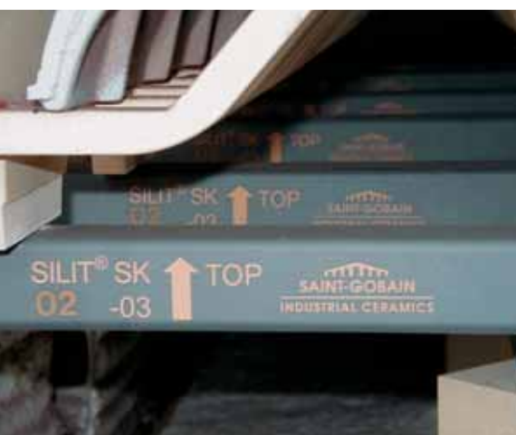
Balken aus Silit® SK und AnnaSicon® RT für die Dachziegelherstellung
