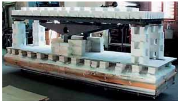
Monolithisches Stützsystem zur Realisierung einetagiger Aufbauten
