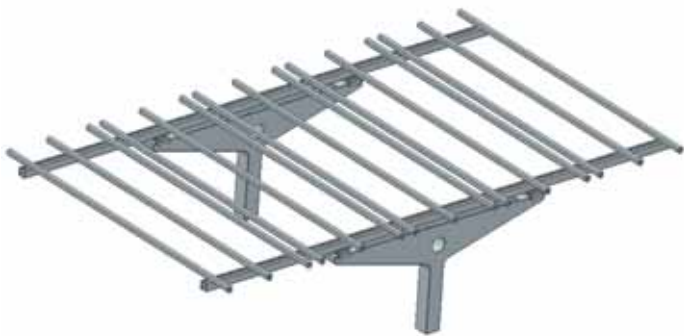
Monolithisches Stützsystem zur Realisierung einetagiger Aufbauten
