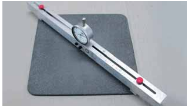
Berührungslose Messung der Ebenheit von flachen Bauteilen
