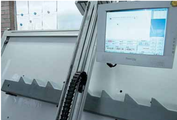
Numerisch kontrollierte Messbank zur Überprüfung von komplexen Bauteilen
